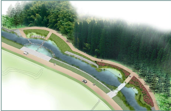
斜め空中写真と合成した鳥瞰図 (ワンドを利用した多自然型川づくりの例、親水護岸や渡河堰を計画し対岸のアクセスを考えた例)
